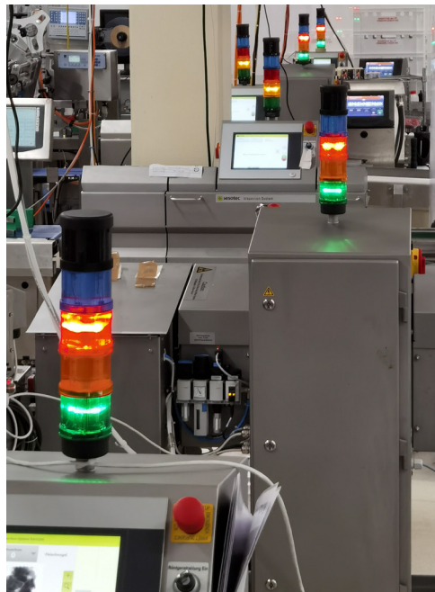
RAYCON EX1 Röntgeninspektionssysteme in neun Linien: Sieben Geräte bei FF Frischfleisch AG und zwei Geräte bei Sempione AG
