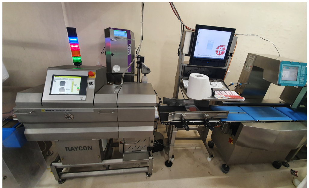
Sesotec RAYCON EX1 Produktinspektionssysteme arbeiten konzertiert mit den Videojet Etikettendruckern nach der Verpackung von Fleisch- und Wurstprodukten in der Warenausgangskontrolle
