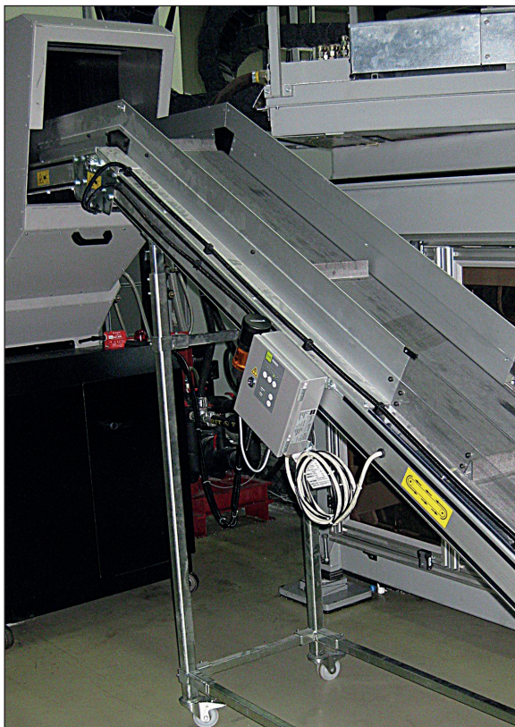
Einbaubeispiel: Mühlenschutz. Flächen-Metalldetektor ELCON eingebaut in das Zuführförderband der Schneidmühle (alte Ausführung)
